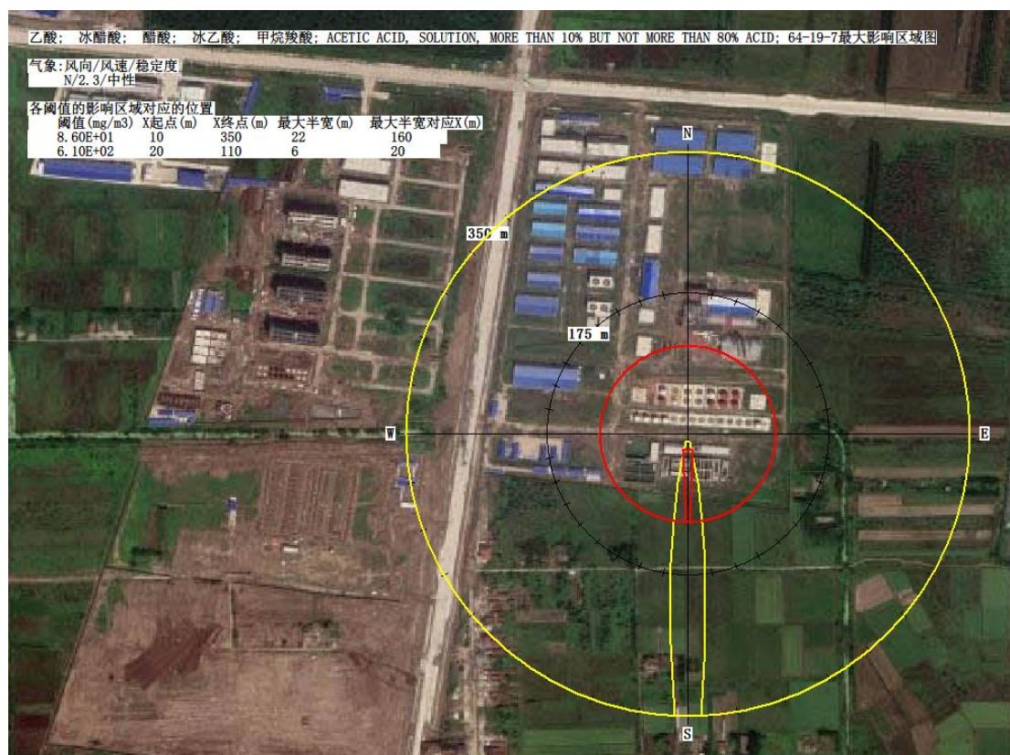
图7.7-8 最常见气象条件下醋酸泄露后阈值最大廓线预测结果图
