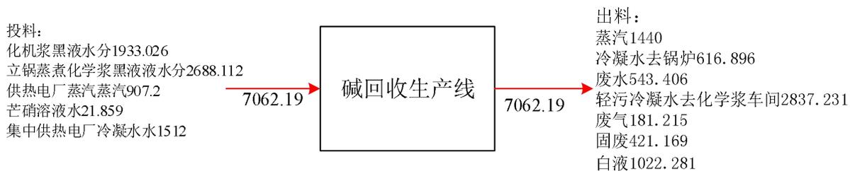
图 3-24 二期碱回收生产系统工艺水平衡图 单位：t/d
