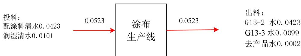
图 3-51 单期涂布热敏纸生产总水平衡图 单位：t/t 产品
