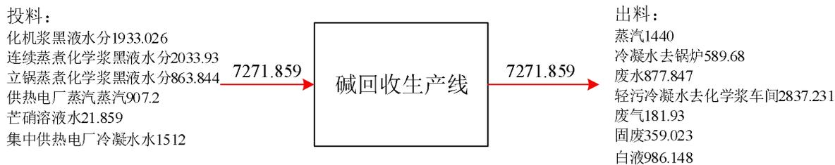
图 3-23 一期碱回收生产系统工艺水平衡图 单位：t/d
