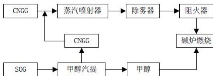
图 3-63 高浓度臭气收集处理流程图
