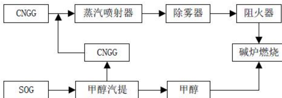
图 4-61 高浓度臭气收集处理流程图
