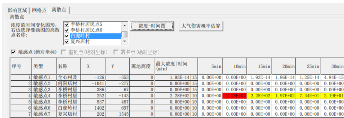
图7.5-31 最不利气象条件下氯磺酸泄露后离散点浓度-时间预测结果图
