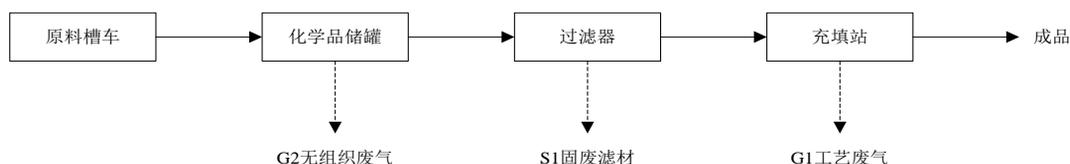
图 2.5-2 储存及分装产品生产工艺流程及产污节点图
