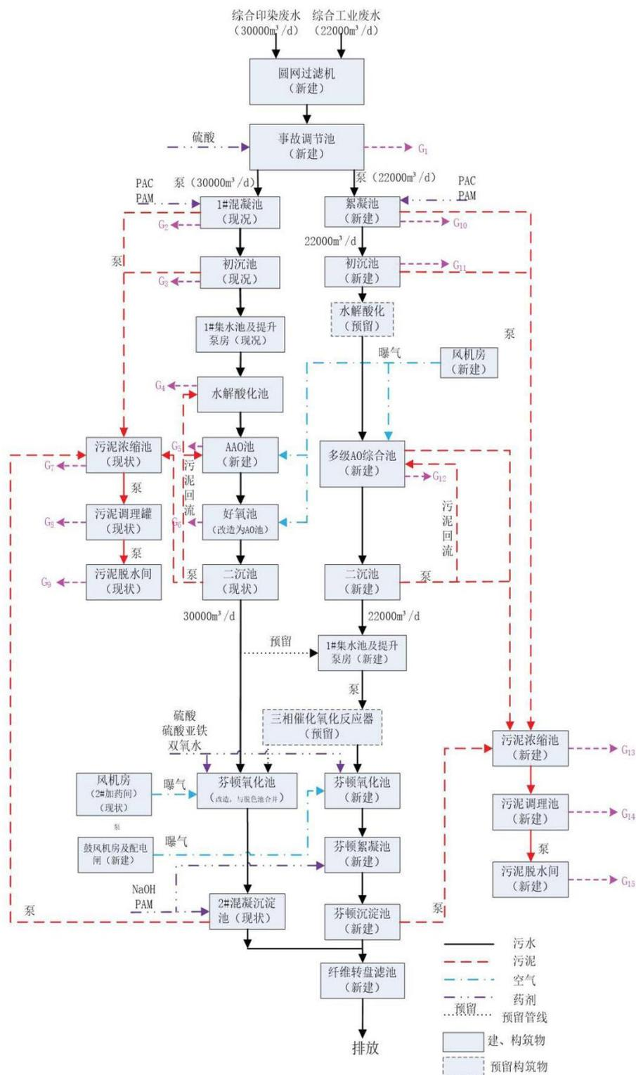
图 6.1-111 荆州申联环境科技有限公司污水处理厂设计工艺流程示意图
