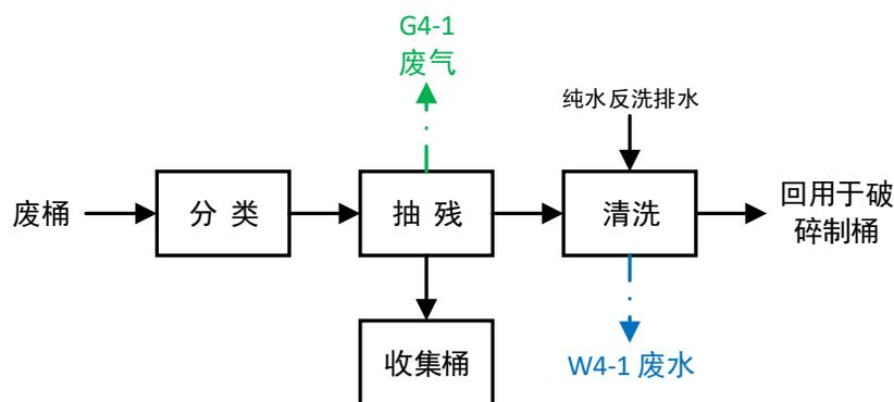
图 4.7-5 洗桶工艺流程及产污节点图
