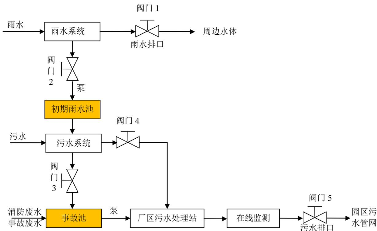
图 7.8-1 事故废水防范和处理流程示意图
