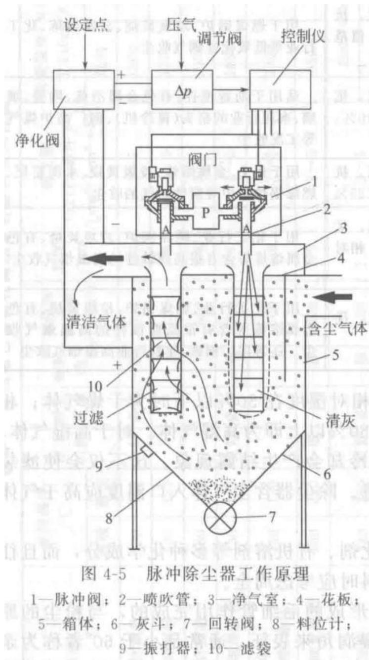
图 8.1-4 袋式除尘器工作原理示意图
