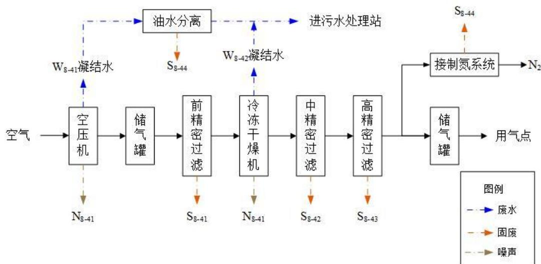
图4.7-4 空压站工艺流程及产污节点示意图
