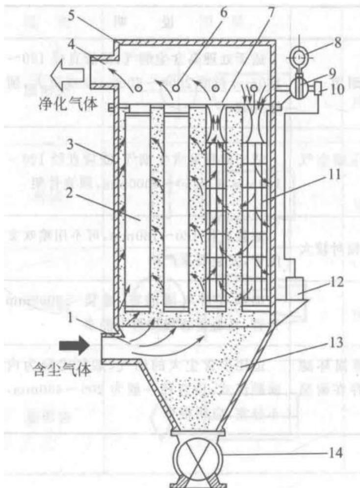
图 4-2 脉冲袋式除尘器
