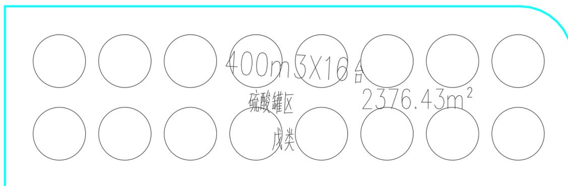
图 3.6-1 硫酸罐区布置示意图
