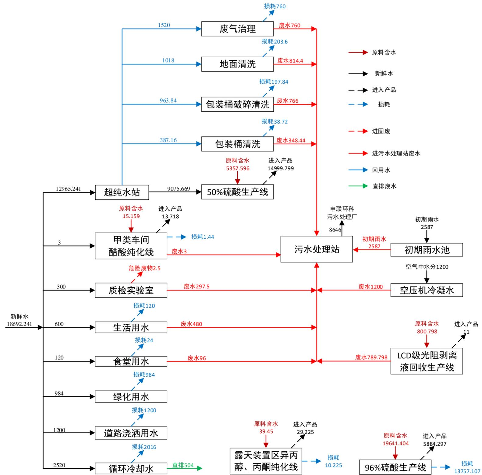
图 4.8-1 本项目水平衡分析图 (单位: m<sup>3</sup>/a)
