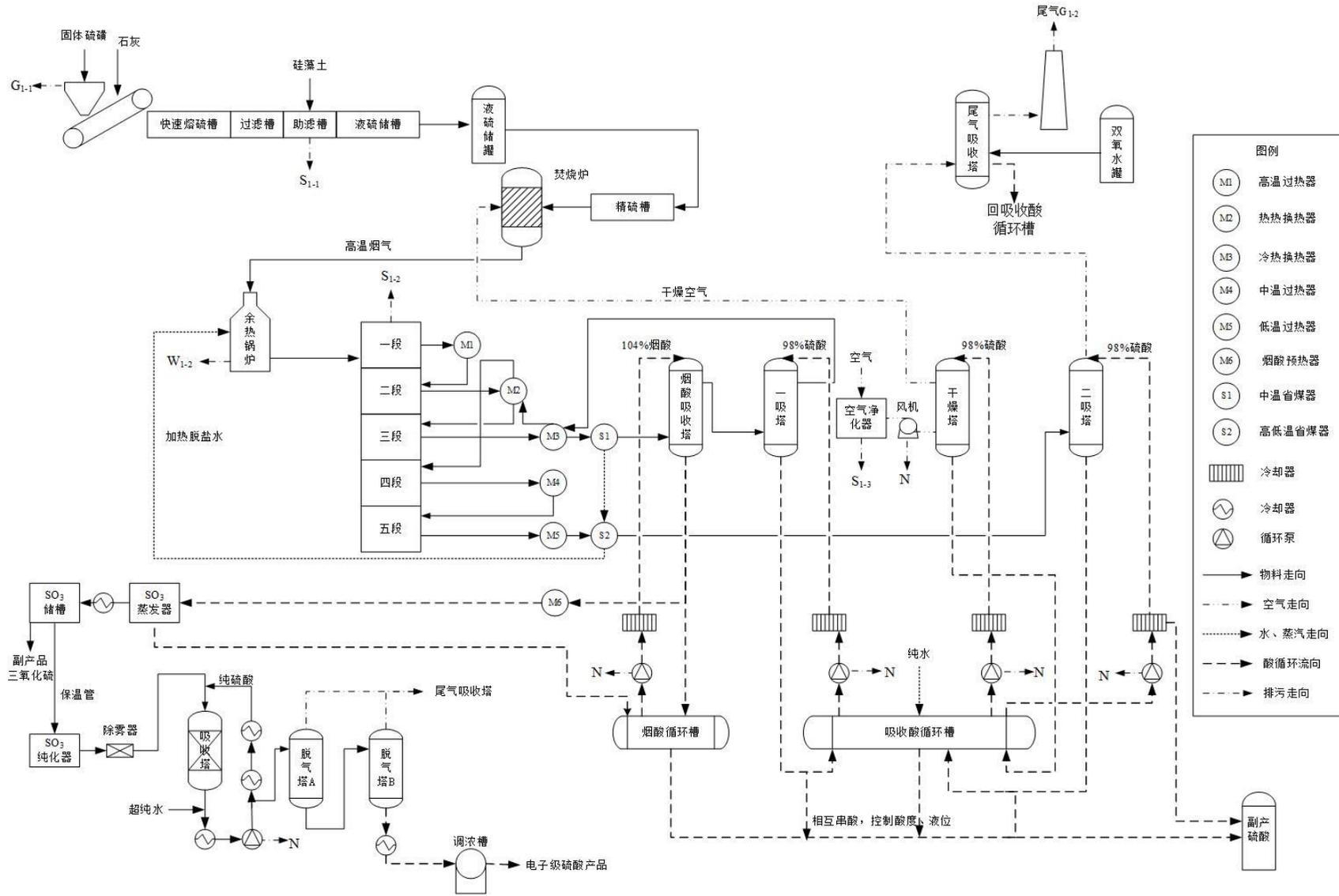
图2.5-3 硫酸生产工艺流程及产污节点图
