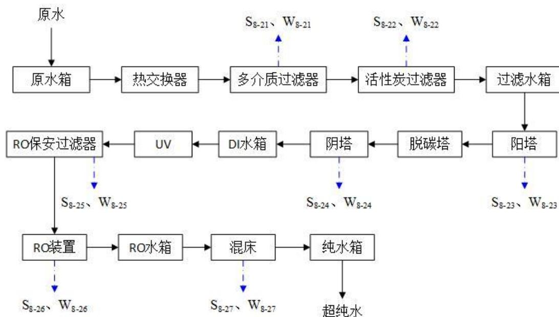
图 4.7-2 超纯水处理站工艺流程及产污节点图
