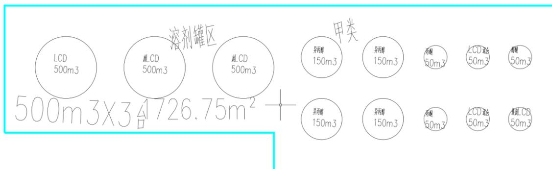
图3.6-2 有机罐区布置示意图
