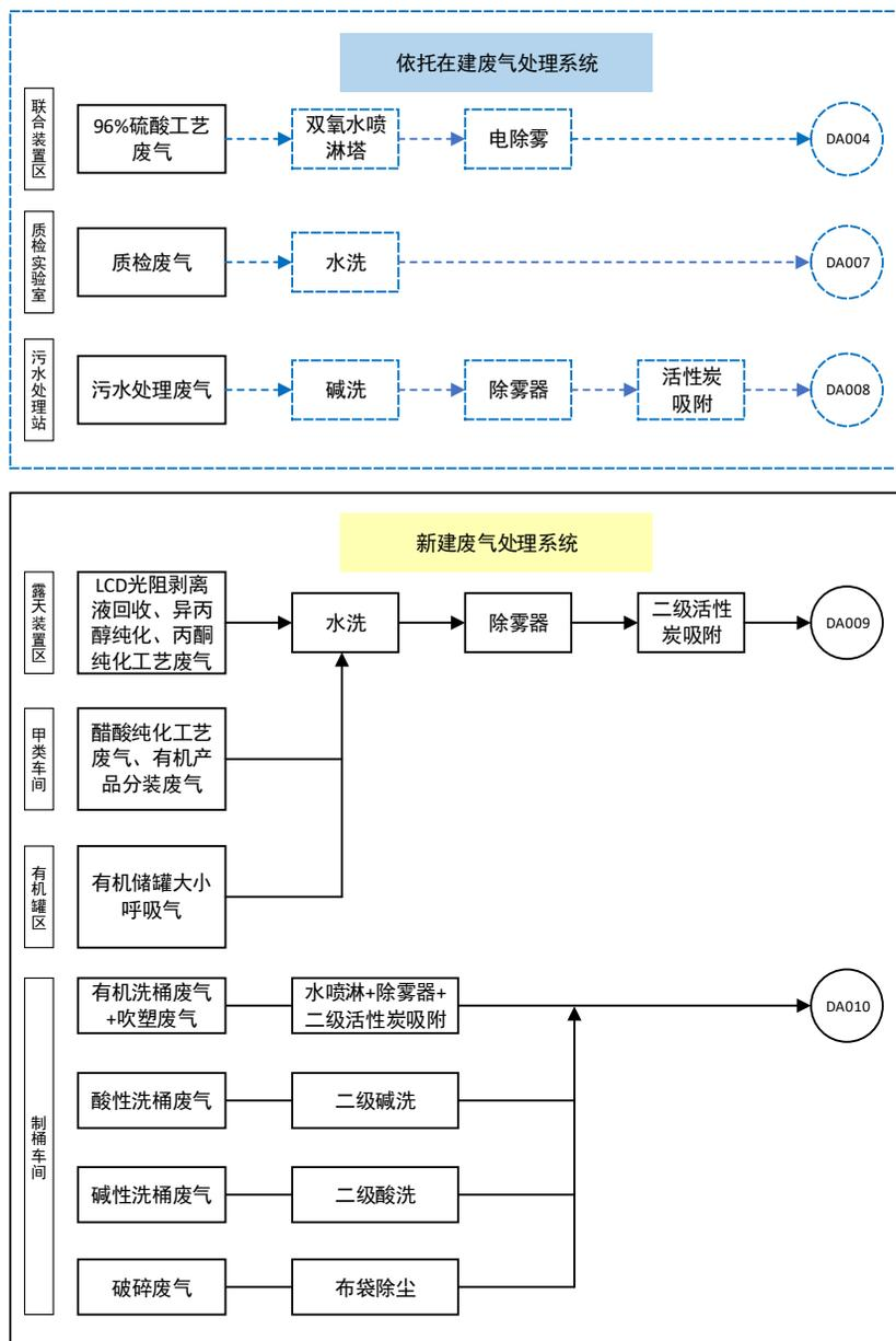
图 8.1-1 项目废气处理路线图
