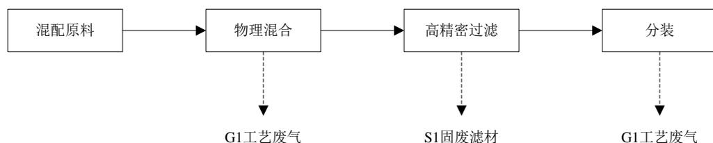
图 2.5-1 混配类产品生产工艺流程及产污节点图
