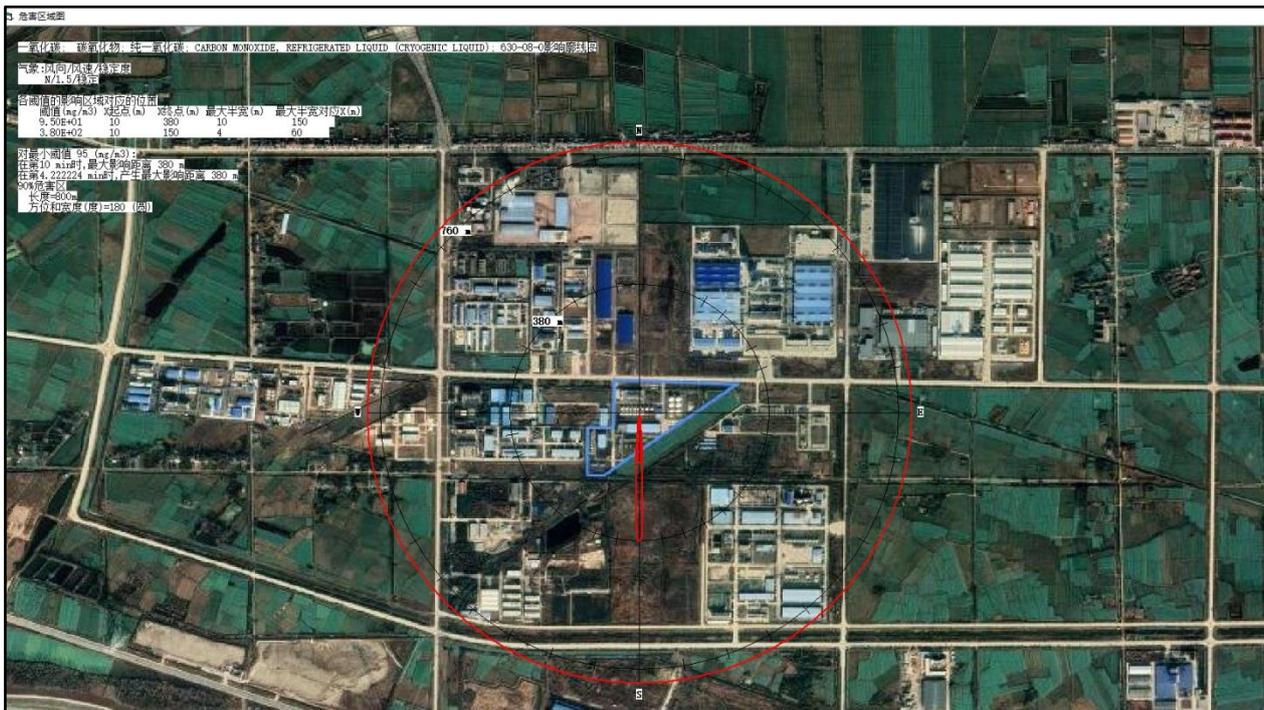
图 4.7-17 CO 扩散过程中第 10min 时的轮廓线图形
