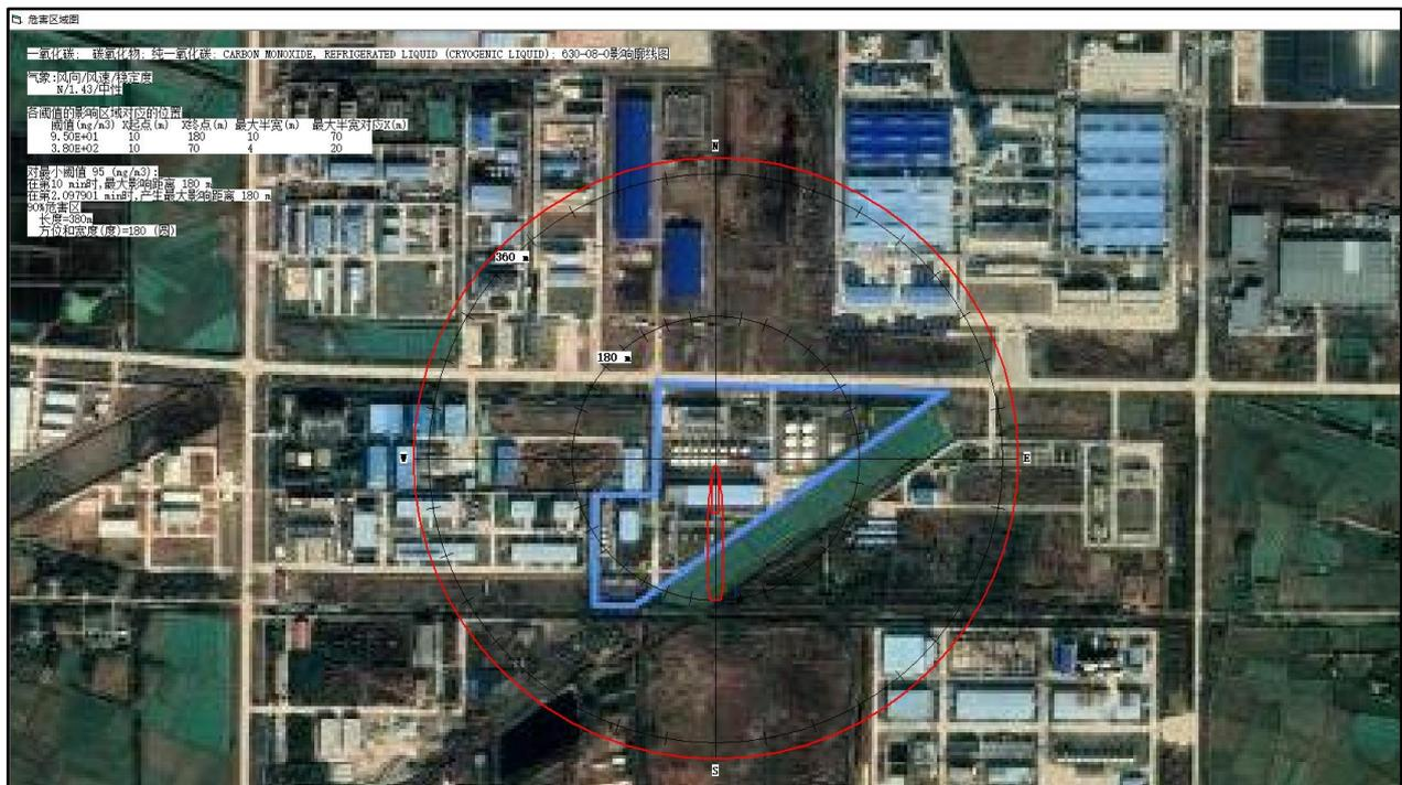
图 4.7-24 CO 扩散过程中第 10min 时的轮廓线图形
