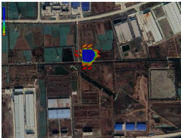
锌非正常工况 1000 天
